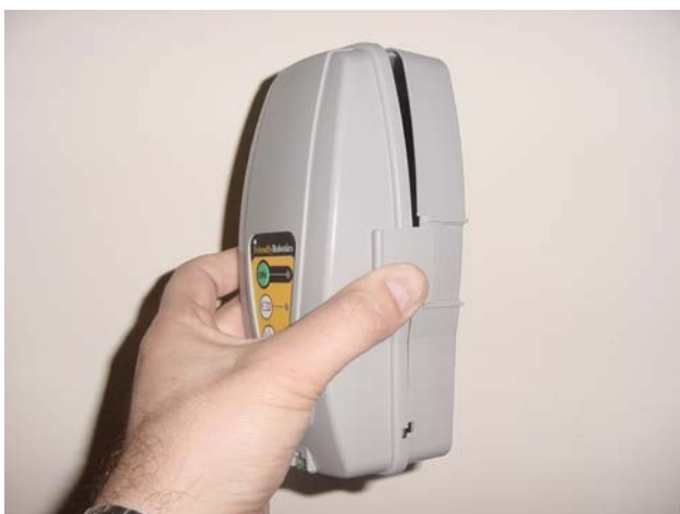
1.31 ábra - Nyomni a burkolat levételéhez
