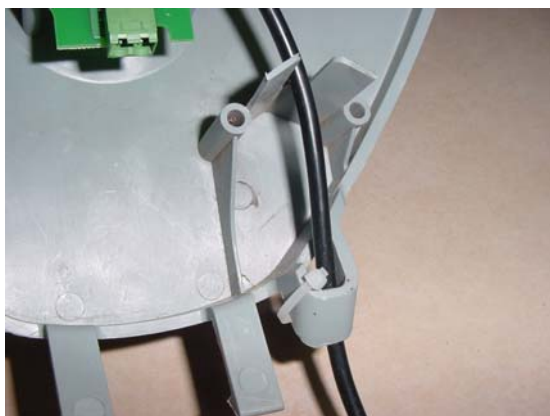
1.18. ábra Az áramellátó vezeték bevezetése a Dokkoló egység belsejébe
