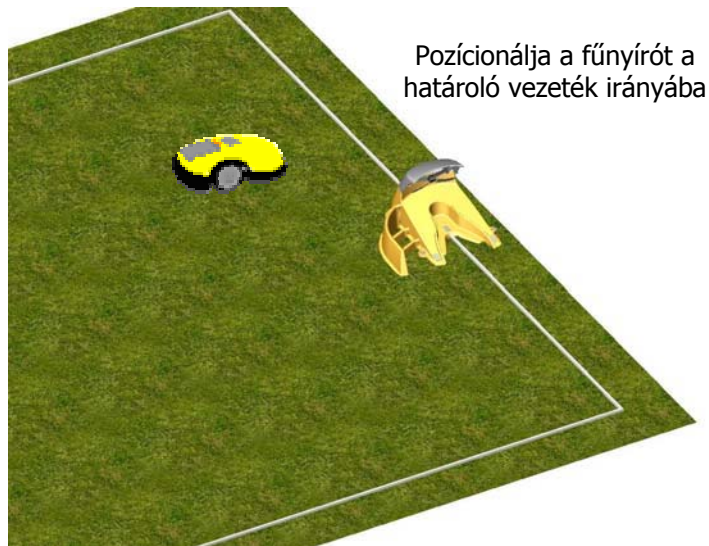
2.12 ábra – A határoló vezeték pozíciójának tesztelése
