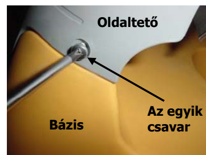
1.22. ábra – Oldaltető és a Bázis rögzítése
