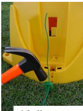
1.8. ábra – A Határoló vezeték a Dokkoló állomásnál (töltő zóna)
