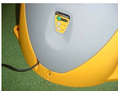
1.21. ábra – Az áramellátó vezeték helyes elvezetése
