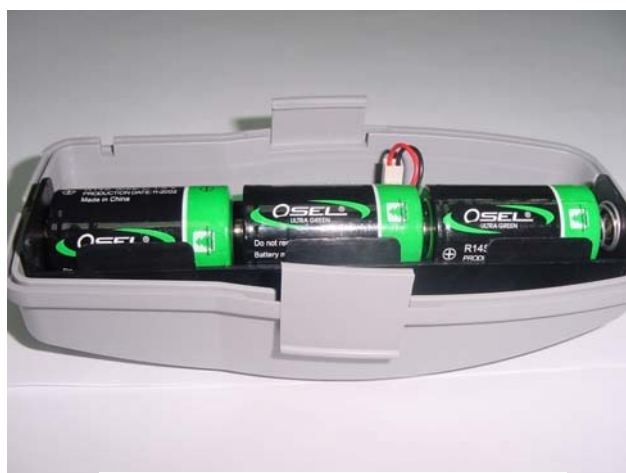
1.32 ábra – Az elemek behelyezése
