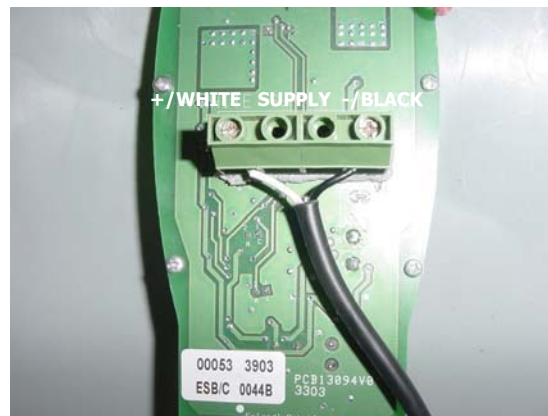
1.19. ábra Az áramellátó vezeték és a műszertábla a Dokkoló állomás belsejében
