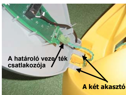
1.20. ábra – Oldaltető és a Bázis illesztése
