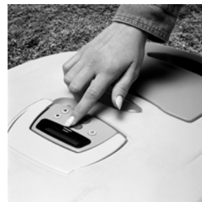
Kézi vezérlő alaphelyzetbe állítása (a Robomow felületével egy szintbe)
