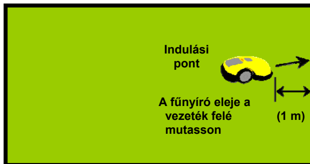
3.1 ábra Robomow elhelyezése a gyepen
