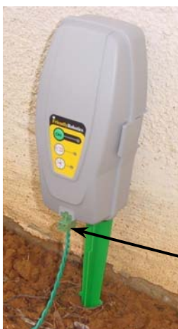
1.35 ábra – Határoló kapcsoló a rögzítő cölöppel
